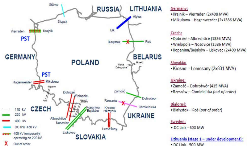
Rys. 6. Połączenia transgraniczne KSE
